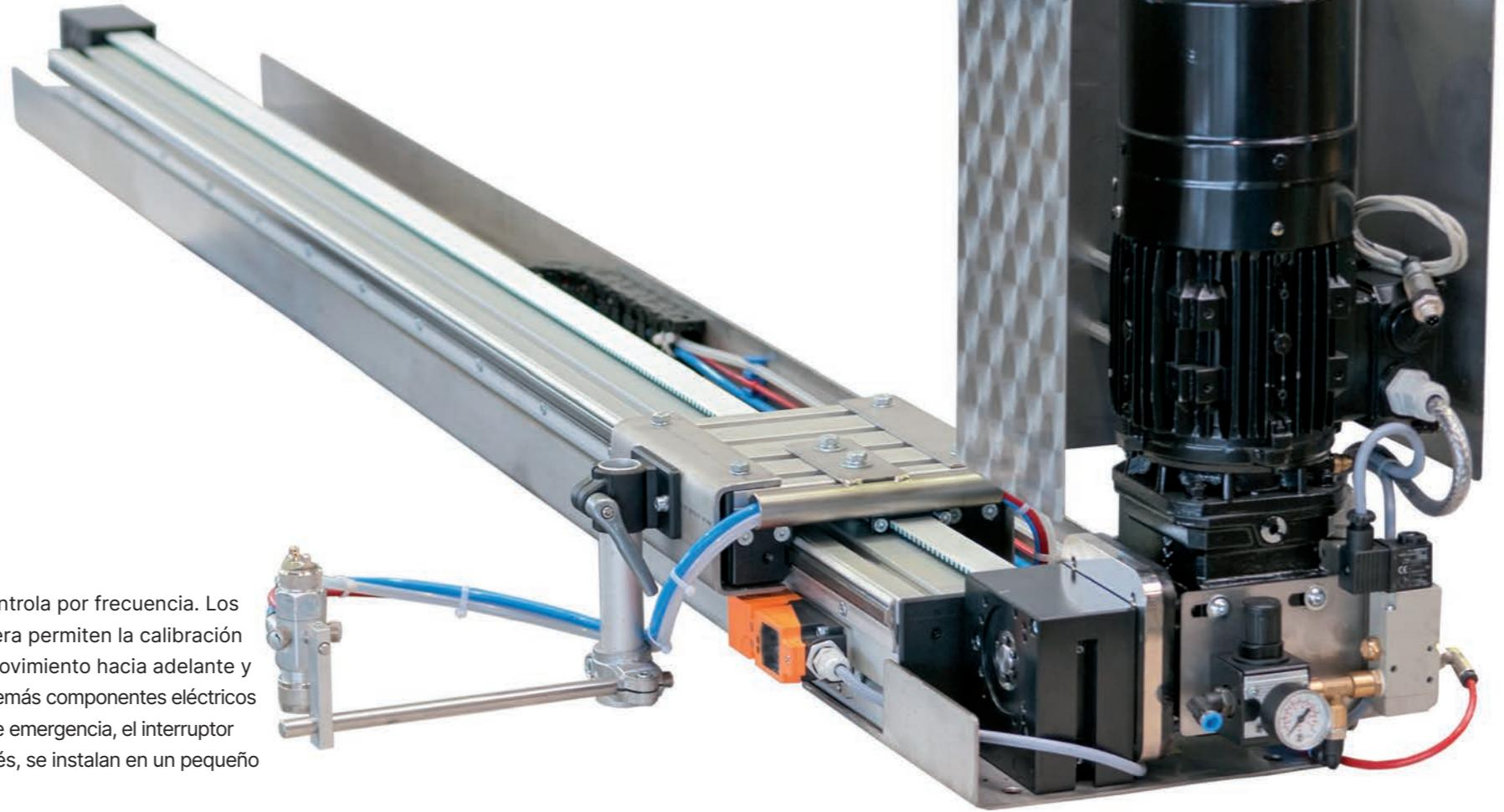
de motor/engranaje y se controla por frecuencia. Los interruptores de fin de carrera permiten la calibración y la conmutación entre el movimiento hacia adelante y hacia atrás. El inversor y los demás componentes eléctricos necesarios, como la parada de emergencia, el interruptor principal, los fusibles y los relés, se instalan en un pequeño armario de distribución.
