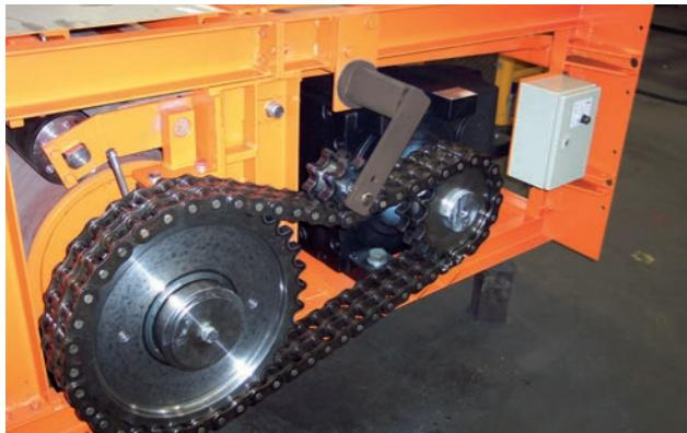
directamente delante del equipo motriz. Este sistema de tensado por rodillo ajusta uniformemente la malla compensando la dilatación térmica. El equipo motriz consta de un motorreductor y una cadena que mueve el rodillo engomado que a su vez generan la tracción de la malla. El guiado de la malla ocurre también a través del equipo motriz.
