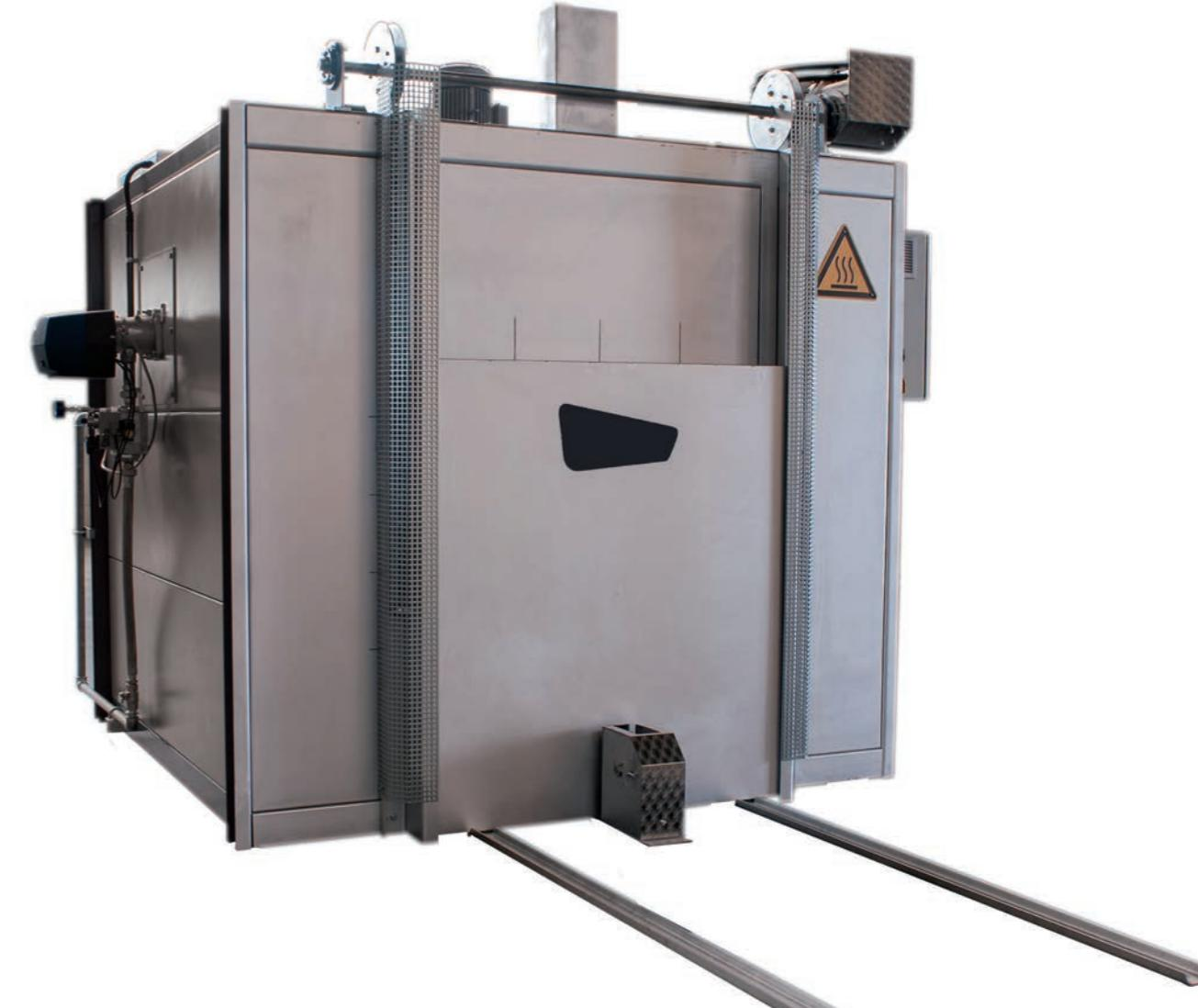
El motor eléctrico para el transporte está situado en la parte trasera del horno protegido del calor. La compuerta aislada está fabricada por la parte interior en acabado de acero inoxidable. Un sistema de guiado de la compuerta posibilita cerrar la misma casi herméticamente así como un abrir fácil.
