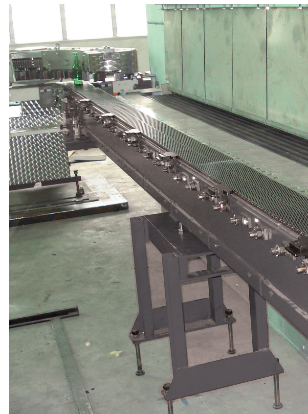
Umlenkung in Sonderausführung bei Einsatz einer Pennekamp-Übergabe
